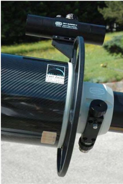
*Ein evolutionäres Zitat des Original-Zeiss Designs: An insgesamt sechs Positionen des RADes lässt sich Zubehör anbringen, z.B. auch ein vollwertiger Sucher, der dann wie beim Original rotierbar ausfällt*
