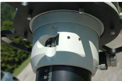
*Die Teile des Okularauszugs sind höchst passgenau. Ohne Schmierung gleitet hier geschmeidig Titanoxid auf Titanoxid. Die Auszugslänge ist mit 130+ mm reichlich*
