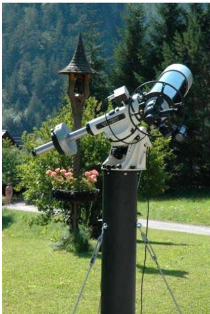
*Durch die ausgeklügelten GOTO- und Justierfunktionen der Montierung findet man mit einem Sky-Surfer als Zielgerät das Auslangen*
