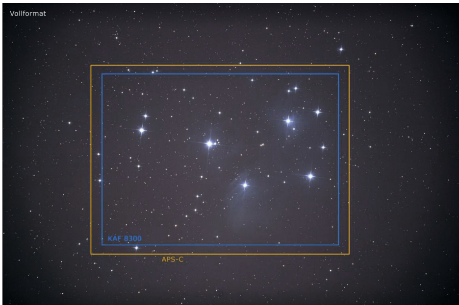
Bild der Plejaden an einem 200 mm f/4 Newton mit Vollformat-Kamera Canon EOS 5D Mark II, 13 x 30 Sekunden. Der gelbe Rahmen zeigt das Bildfeld einer APS-C-Kamera, der blaue das des verbreiteten KAF 8300 Sensors vieler CCD-Kameras. Die Vignettierung entstand durch die T-2-Adaption und kann durch den Canon EOS Protective T-Ring mit M48-Gewinde deutlich reduziert werden.
