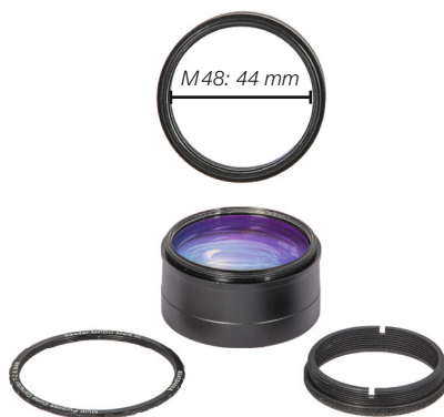
MPCC Basiselement ohne Stop-Ring und T-2-Adapter: 44 mm freier Durchlass mit M48-Anschluss
