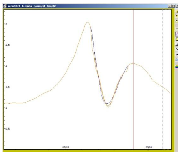
Abb. 79: Anpassung eines Gaußprofils an die Absorptionseinsenkung
