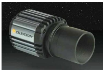
Abb. 23: Ein großer Sensor wie der der Skyris 274M ist von Vorteil, damit der Stern nach dem Anfahren sicher gefunden werden kann.
