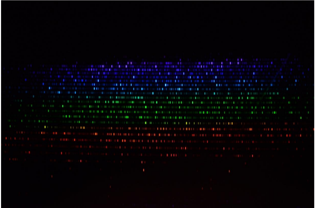
Abb. 11: Spektrum der ThAr-Lampe mit unmodifizierter DSLR-Kamera
