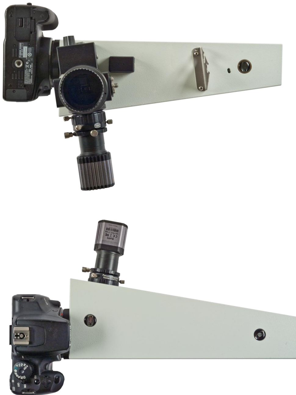
Abb. 4: Eine DSLR-Kamera wird mittels eines T2-Rings angeschlossen
