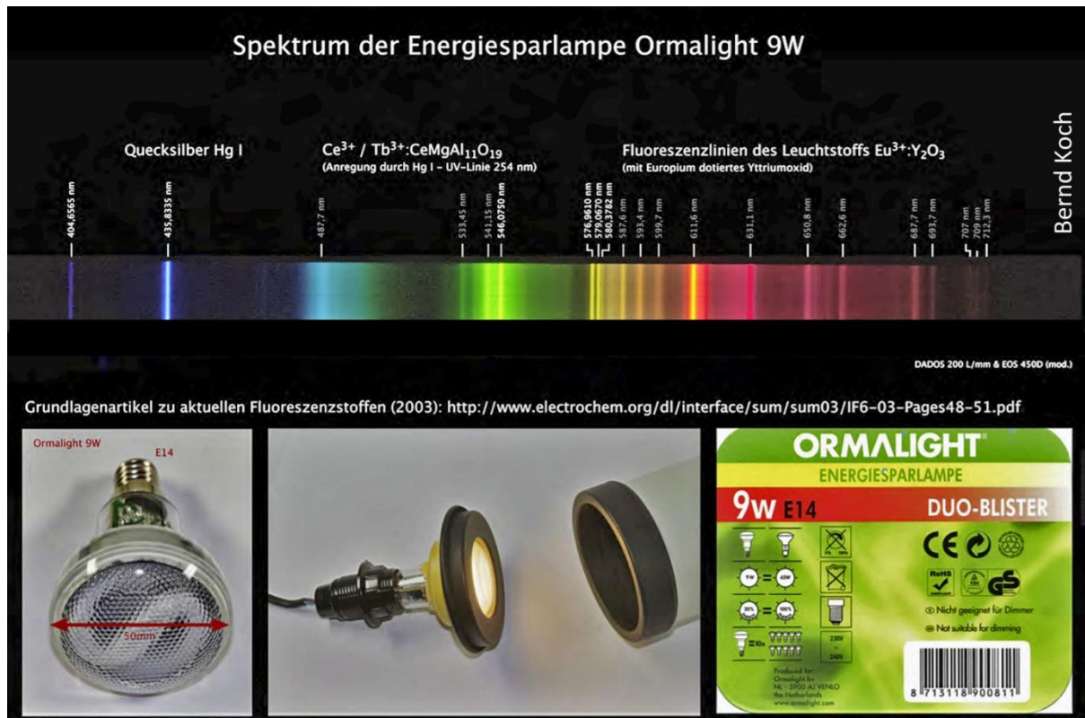
Abb. 5: Spektrum der ESL Ormalight, aufgenommen mit dem DADOS Spaltspektrografen und dem 200 L/mm Gitter
