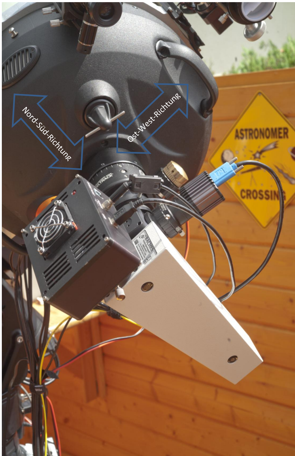
Abb. 28: Bevorzugte Ausrichtung der einzelnen Komponenten der Aufnahmeanordnung
