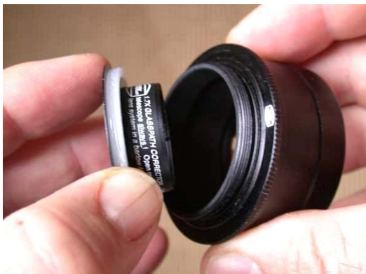
Das Bild zeigt, wie man den Glaswegkorrektor in den optionalen T2 (#16) 2"-Adapter einsetzt. Der weiße Plastikring muss auf das Gewinde des GWKs gedrückt werden, damit dieser mittig in dem Adapter sitzt.
