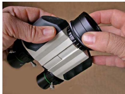
Nachdem der Glaswegkorrektor in der 2"/T-2 Steckhülse #16 zentriert ist, schraubt man diese direkt auf das T-2 Gewinde vorne am Maxbright-Binokular.
