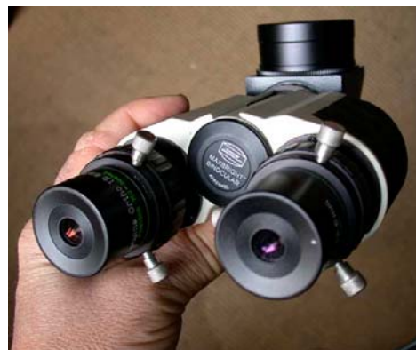
Der Maxbright Bino-Ansatz mit T2 (#1B) Zeiss-Prisma und 2"-Adapter #16
