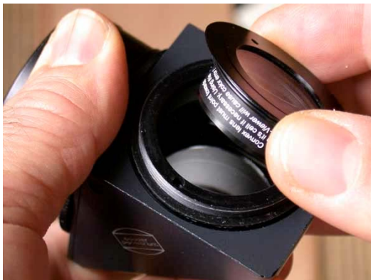
So schrauben Sie den Glaswegkorrektor in die verschiedenen Baader T2 Prismen und Spiegel #1A/1B/1C
