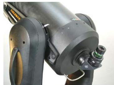
Am Celestron C8" GPS: Maxbright Zenit Spiegel mit 35mm Öffnung, daher ohne Vignettierung – bestehend aus Baader T-Adapter (#21), T-2 Zenit Spiegel (#1A), ClickLock (#8)
