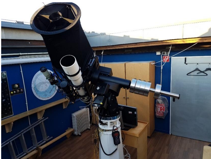
Abb.27: CDK20 Teleskop (schwarzes Teleskop), GM4000 Montierung mit Gegengewichten und Säule
