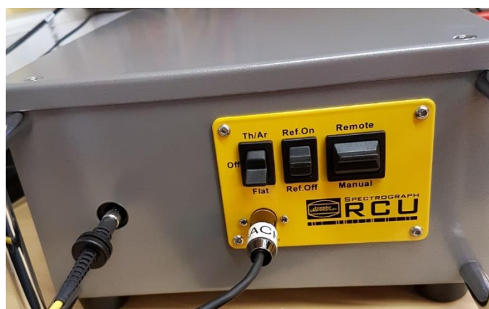
Abbildung 19 – Remote calibration Unit (RCU) mit Referenzlampen
