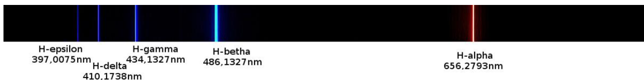
Abbildung 6 Balmer-Serie Wasserstoff (Bild durch Autoren bearbeitet: H-zeta fehlt)
