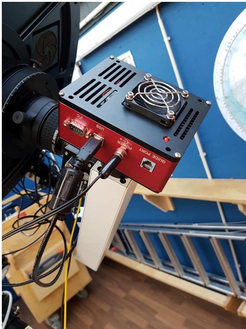
Abbildung 26 – CCD Kamera STF 8300M
