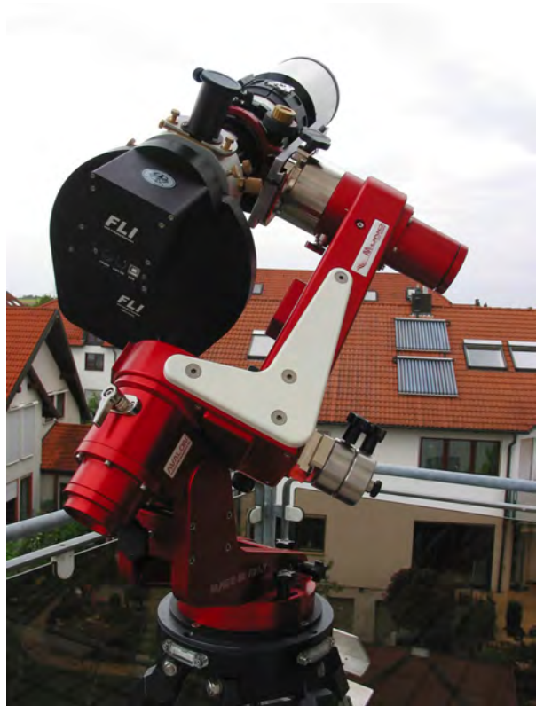
11 kg auf der Avalon: TEC 110 FL mit Flattener sowie eine FLI ML 16803 CCD-Kamera mit 7-fach Filterrad.
