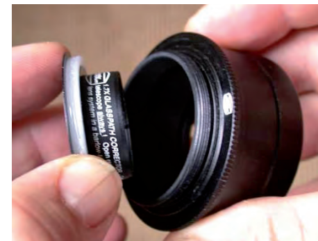
Einbau des Glaswegkorrektor in den optionalen T2 (#16) 2"-Adapter (ohne Zenitspiegel). Der weiße Plastikring muss auf das Gewinde des GWKs gedrückt werden, damit dieser mittig in dem Adapter sitzt.
