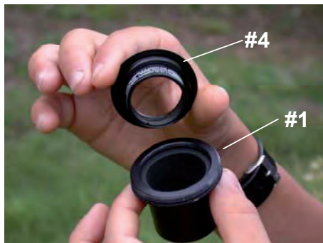
Die 1,25x und 1,7x Glaswegkorrektoren werden in die 1¼" Steckhülsen eingeschraubt, wenn der Binokularansatz ohne Zenitprisma verwendet werden soll.
