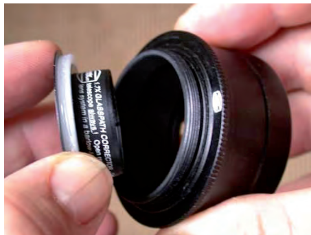
Einbau des 1,25x oder 1,7x Glaswegkorrektors in den optionalen T2 (#16) 2"-Adapter (ohne Zenitspiegel). Der weiße Plastikring muss auf das Gewinde des GWKs gedrückt werden, damit dieser mittig in dem Adapter sitzt.
