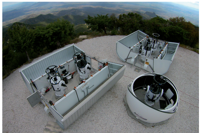
Fünf CDK700-Teleskope an der Caltech/MINERVA Installation auf dem Mount Hopkins in Arizona
