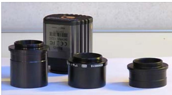
Zum besseren Verständnis zu den Fußnoten 2, 3 und 4. Von links nach rechts: Celestron Standardhülse, Baader Hülse # 295 8515 und Baader Hülse # 295 8515 maximal gekürzt, so dass das Q-Turret Barlowlinselement gerade noch – ohne anzustoßen – bis zum Anschlag einschraubbar ist.
