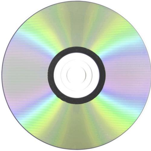
Abb. 2: Die CD ist ein Reflexionsgitter. Sie erzeugt ein kontinuierlich verlaufendes Farbspektrum, wenn man eine helle Lichtquelle damit im reflektierenden Licht betrachtet.
