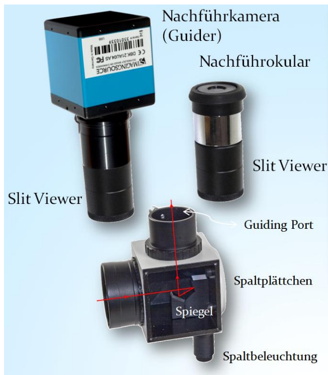
Abb. 6: Nachführung ("Guiding") am so genannten "Guiding-Port" des Spaltwürfels 1: Visuell mit Nachführkular oder bequem mit Videokamera
