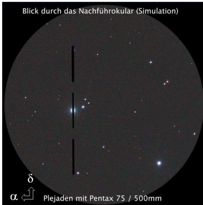
Abb. 4: Ein heller Stern befindet sich vor dem mittleren Spalt mit nur 25 Millionstel Meter Breite. Sein Licht geht durch den Spalt hindurch und wird nach Reflexion am Gitter in seine Spektralfarben zerlegt. Man erkennt im Spektrum charakteristische dunkle Linien. Anhand des Linienmusters kann man erkennen, um welches Element es sich in der Sternatmosphäre handelt; in diesem Fall ist es das Absorptionsmuster des Wasserstoffs, dem häufigsten Element im Universum.
