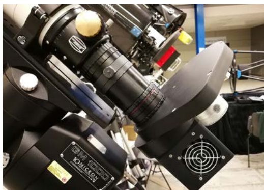
Der Backfokus von 150 mm ist für die Fotografie optimiert, sodass der Okularauszug nur wenig ausgefahren werden muss – ideal für schwerste Lasten. Für die visuelle Nutzung kann der Tubus gekürzt werden.
