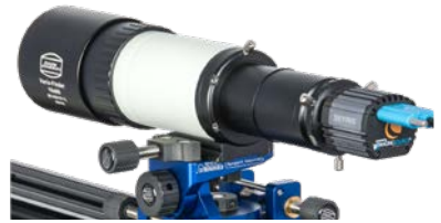
Vario-Finder mit 40mm T-2-Verlängerung #1508153 zwischen Okularauszug und Okularklemme für den Anschluss einer Kamera.
