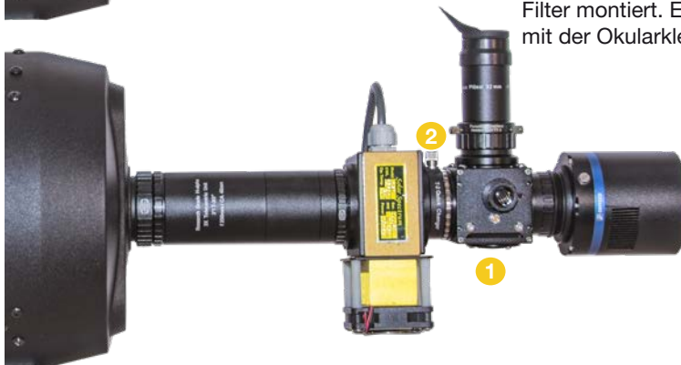
Der Flip Mirror II hinter dem Baader SunDancer II (oben) bzw. einem SolarSpectrum Filter (unten).
