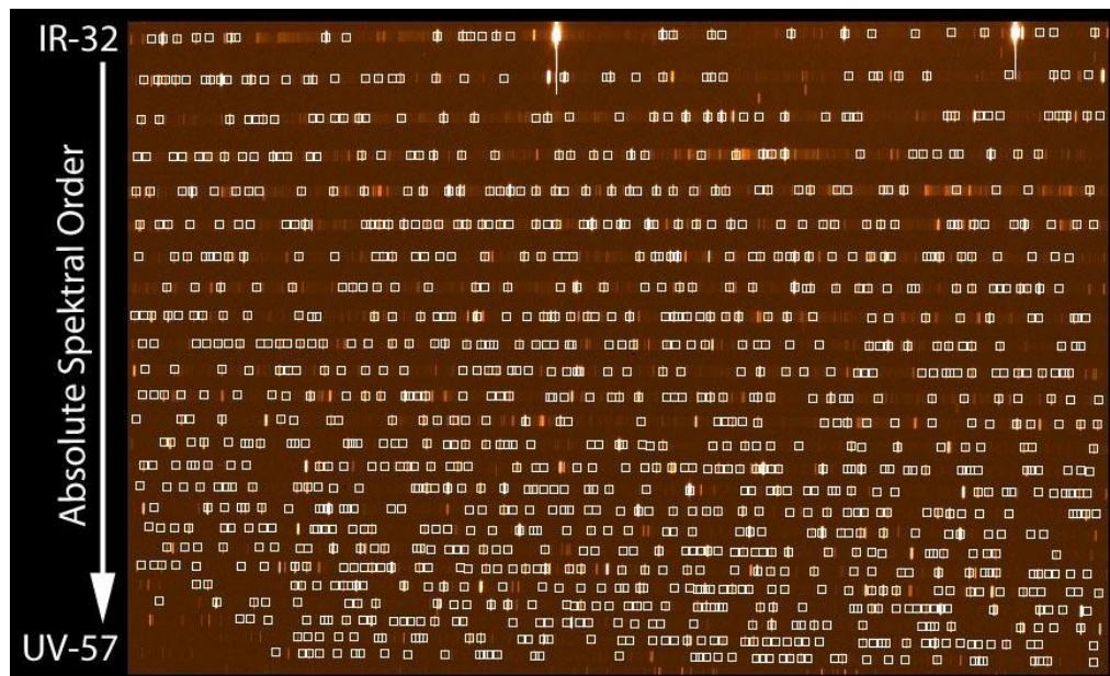
Abb. 36: ca. 1946 Linien werden zunächst erkannt. MIDAS muss für eine genaue Kalibrierung möglichst viele davon verwenden, gefordert sind mindestens 50%, optimaler Weise 80%
