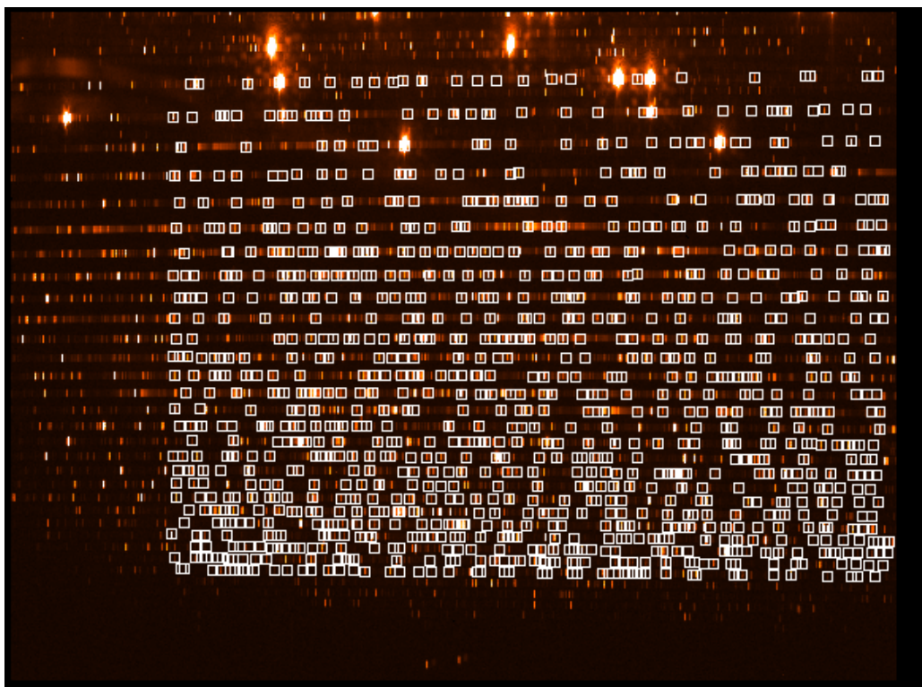
Abb. 64: Für die Kalibrierung verwendete ThAr-Linien
