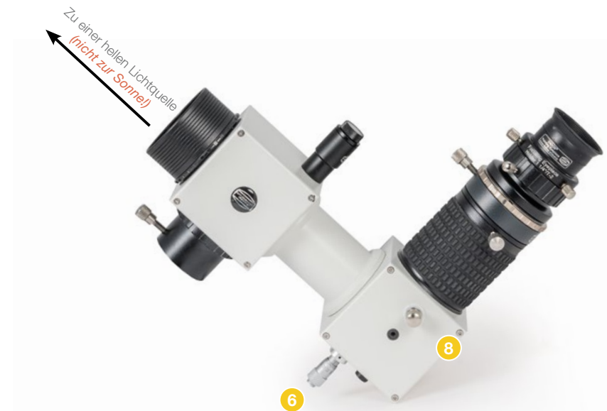
Einstellen des Spektralbereichs über die Mikrometerschraube 6 nach Lockern der Feststellschraube 8
