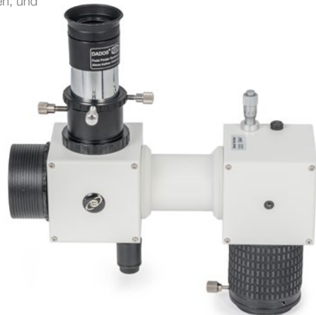
Der DADOS mit Nachführokkular. Der Stopping markiert die Schärfeposition.
