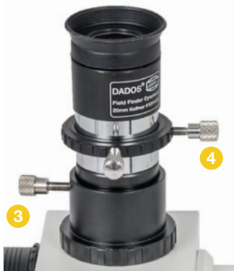
Verschieben Sie das Nachführokkular, bis Sie die drei Spalte scharf sehen, und fixieren es dann.
