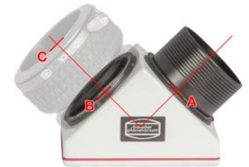
Der benötigte Backfokus lässt sich von 112 mm mit ClickLock® (A-C) auf etwa 71,5 mm ohne ClickLock® reduzieren (A-B).
