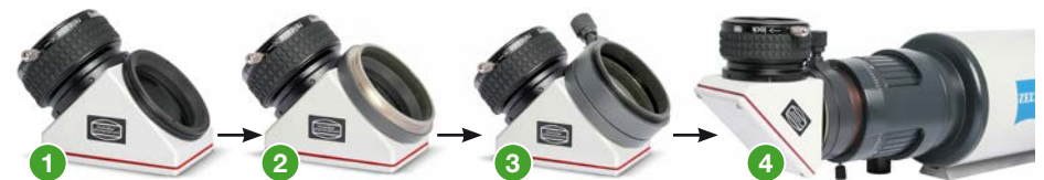
Adaption des M68-Zenitspiegels: 1 Das freiliegende M68-Gewinde 2 Mit M68/S68 Zeiss Wechselring #2458180 3 Zusätzlich mit S68/M68-Zeiss-Wechsler #2458185 4 Montiert am Zeiss APQ Teleskop. Mit dem Ring #2458234 kann auch die okularseitige ClickLock® durch einen M68-Schnellwechsler ersetzt werden.
