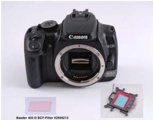
Auf vielfachen Wunsch haben wir ein Filter für die 400D entwickelt - vor allem deshalb, weil es uns gelungen ist, die Funktion des Piezo "Staubbrüttlens" bei der 400D zu erhalten.
