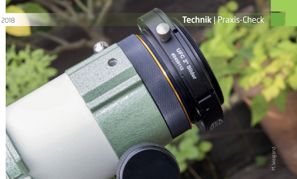
▲ Abb. 3: Dieser M68-Adapter am Okularauszug eines Refraktors besitzt ein zu langes Gewinde und blockiert die Filterschublade. Eine Lösung ist das Erhöhen der Auflagefläche mit einem 1mm dicken Distanzring (Orange).
