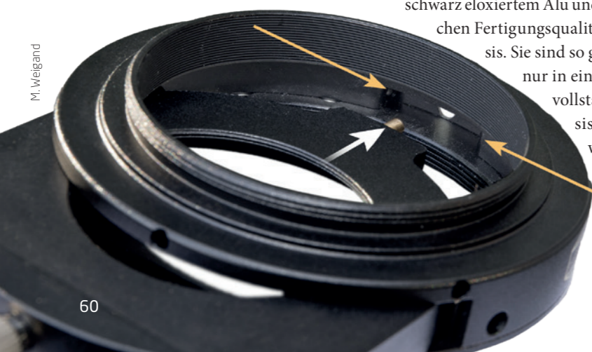
▲ Abb. 2: Die Passfeder mit Passstift an der Filterschublade (weißer Pfeil) und die seitlichen gefederten Druckstücke in der UFC-Basis (gelbe Pfeile) sorgen für eine reproduzierbare Positionierung des Filters.
