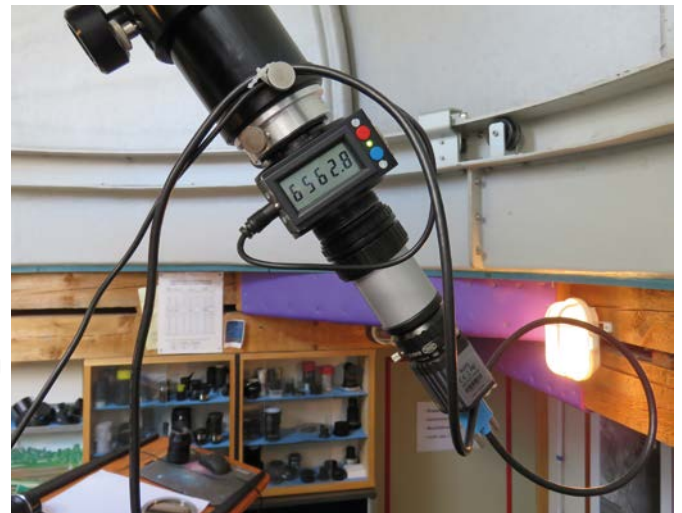
Kabelsicherung an H-alpha-Filtern: Geschlaufte, zugenastete Kabel USB 3.0 und Spannungsversorgung, befestigt an der Klemmschraube des Okularauszuges.
