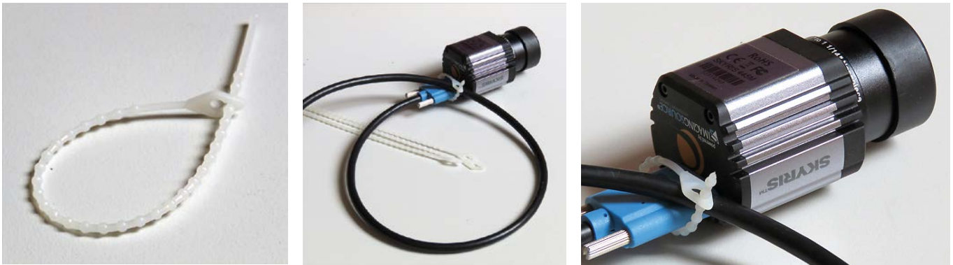
Abb. 01: wieder zu öffnender Kabelbinder (Knotenband). Abb. 02 und 03: Kabelschleufe direkt am USB 3.0 Stecker einer SkyRis Kamera mit Knotenband zur Sicherung
