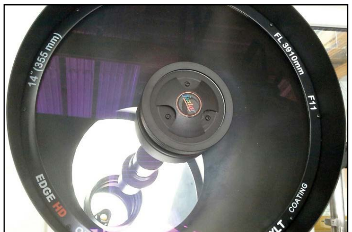
C14 EdgeHD mit beschlagener Schmidtplatte (im rechten Drittel, diagonal)
