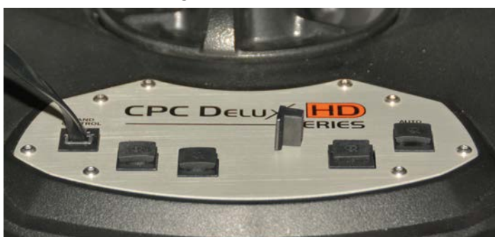
Abdeckkappen verhindern, dass Feuchtigkeit in unbelegte Buchsen gelangen kann oder Kabel falsch angeschlossen werden und zu Kurzschlüssen führen.
