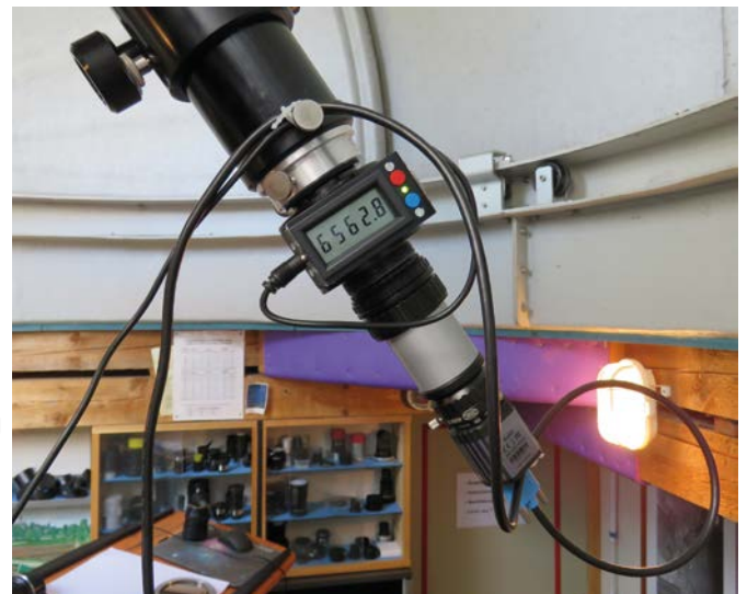
Kabelsicherung an H-alpha-Filtern: Geschlaufte, zugenastete Kabel USB 3.0 und Spannungsversorgung, befestigt an der Klemmschraube des Okularauszuges.
