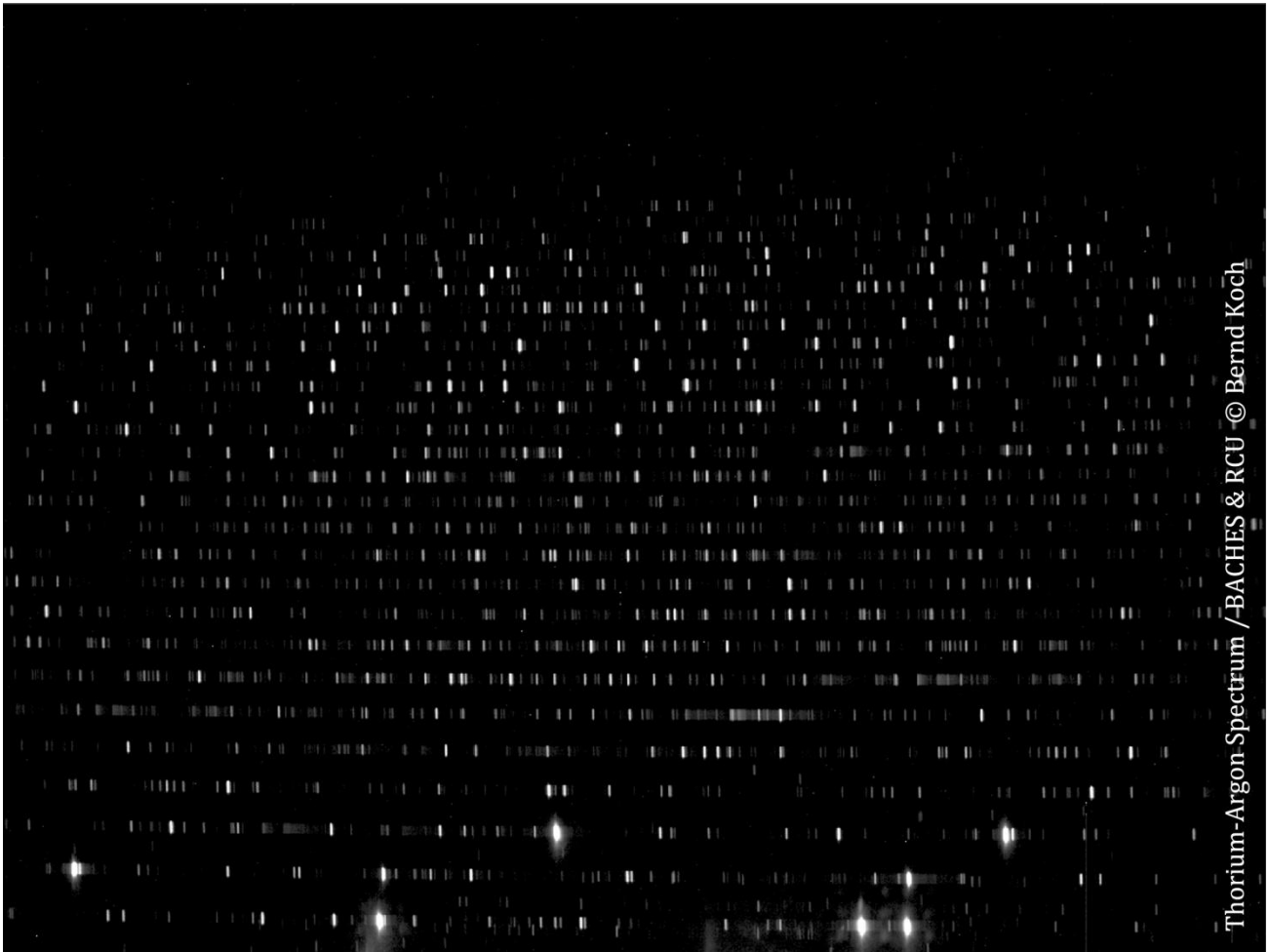
Abb. 3: Thorium-Argon-Referenzspektrum (ThAr). Das Licht der ThAr-Kalibrierlampe der Remote Calibration Unit (RCU) wird mittels eines 2,5m langen Glasfaserkabels in den BACHES Echelle Spektrografen eingespiegelt. Die Einspiegelung erfolgt über eine Steuerleitung. Die Aufnahme erfolgte mit einer SBIG ST-8300M CCD-Kamera im 2x2-Binning bei 10,8 \mu m Pixelgröße kurz vor Aufnahme des Sternspektrums. Es handelt sich um eine Einzelaufnahme mit 20s Belichtungszeit, von der ein Darkframe subtrahiert wurde
