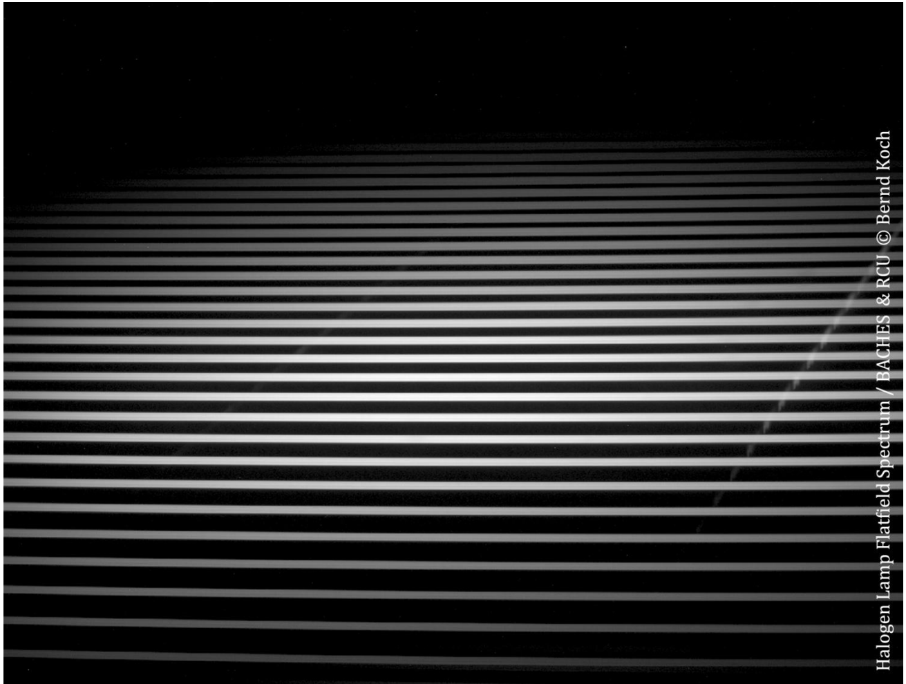
Abb. 4: Das Spektrum der Halogenlampe dient als Flatfield-Spektrum zur Korrektur der Einflüsse von Staub auf die gemessene Lichtintensität in der Aufnahmeeinheit. Das Licht der Halogenlampe der Remote Calibration Unit (RCU) wird mittels eines 2,5m langen Glasfaserkabels in den BACHES Echelle Spektrografen eingespiegelt. Die Aufnahme erfolgte mit einer SBIG ST-8300M CCD-Kamera im 2x2-Binning bei 10,8 \mu m Pixelgröße kurz vor Aufnahme des Sternspektrums. Es handelt sich um eine Einzelaufnahme mit 20s Belichtungszeit, von der ein Darkframe subtrahiert wurde
