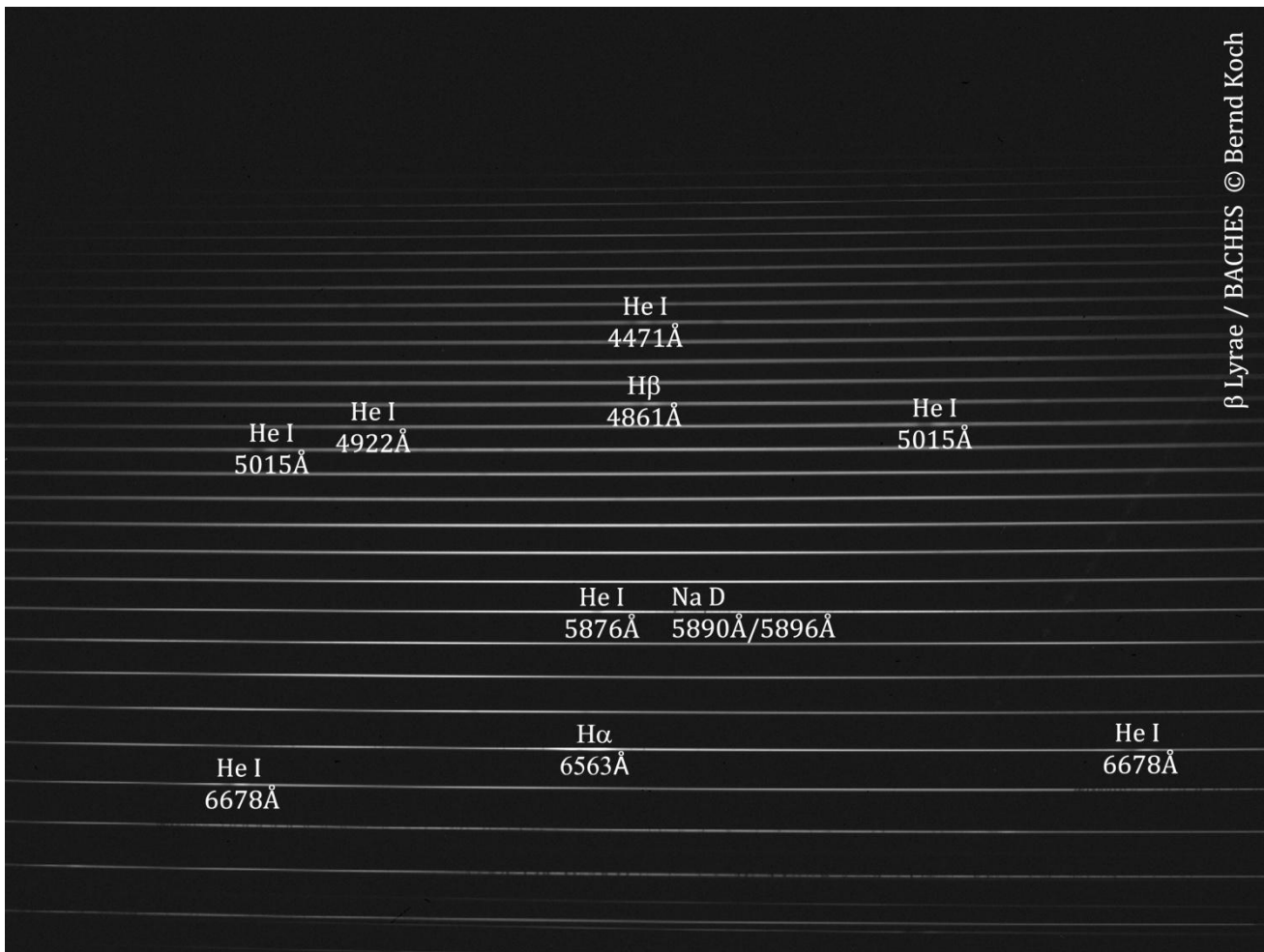
Abb. 2: Spektrum des symbiotischen Doppelsterns \beta Lyrae, aufgenommen am 8.6.2014 um 00:07:24 UT mit dem BACHES Echelle Spektrografen und einer SBIG ST-8300M CCD-Kamera im 2x2-Binning bei 10,8 \mu m Pixelgröße. Es handelt sich um eine Einzelaufnahme mit 300s Belichtungszeit, von der ein Darkframe subtrahiert wurde. Das Spektrum entstand am Astro-Physics 130mm EDF-S Apo-Refraktor bei f/6
