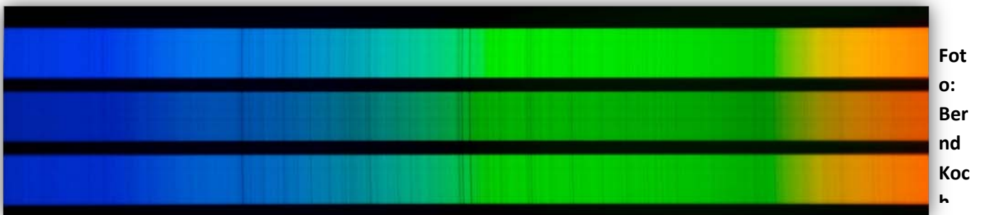
Abbildung 7: Original-Tageslichtspektrum in voller Breite, aufgenommen mit dem DADOS und der Canon EOS 10D im APS-C-Format 15x23mm. Pixelgröße: 7,4µm, Spaltbreite oben 35µm, Mitte 25µm, unten: 50µm. Gitter: Thorlabs GR25-1850, 1800 L/mm
