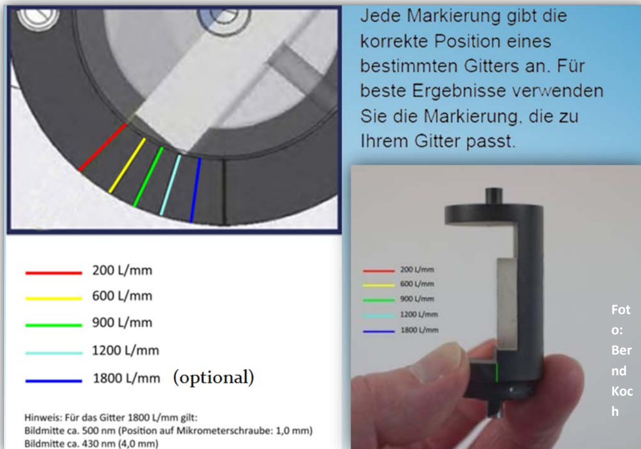
Abbildung 5: Position der Gitterhalter mit den Gittern 200 L/mm bis 1800 L/mm im DADOS (blaue Markierung)
