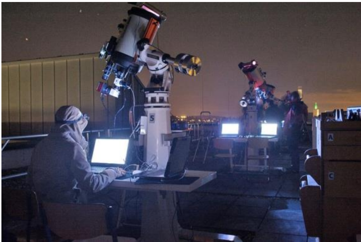
Abendliche Sternspektroskopie mit dem DADOS-Spaltspetrografen an einer der sechs Teleskopeinheiten, die jeweils mit einem C11 EdgeHD auf Astro-Physics GTO900-Montierung ausgestattet sind. Foto: © Dr. Thomas Schröfl (2013)
